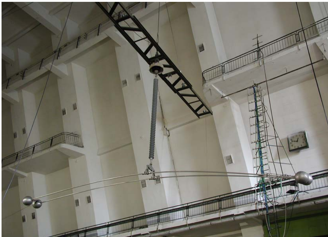
Obrázek 10 - Uspořádání závěsu 400 kV – JN 1 x FURUKAWA
