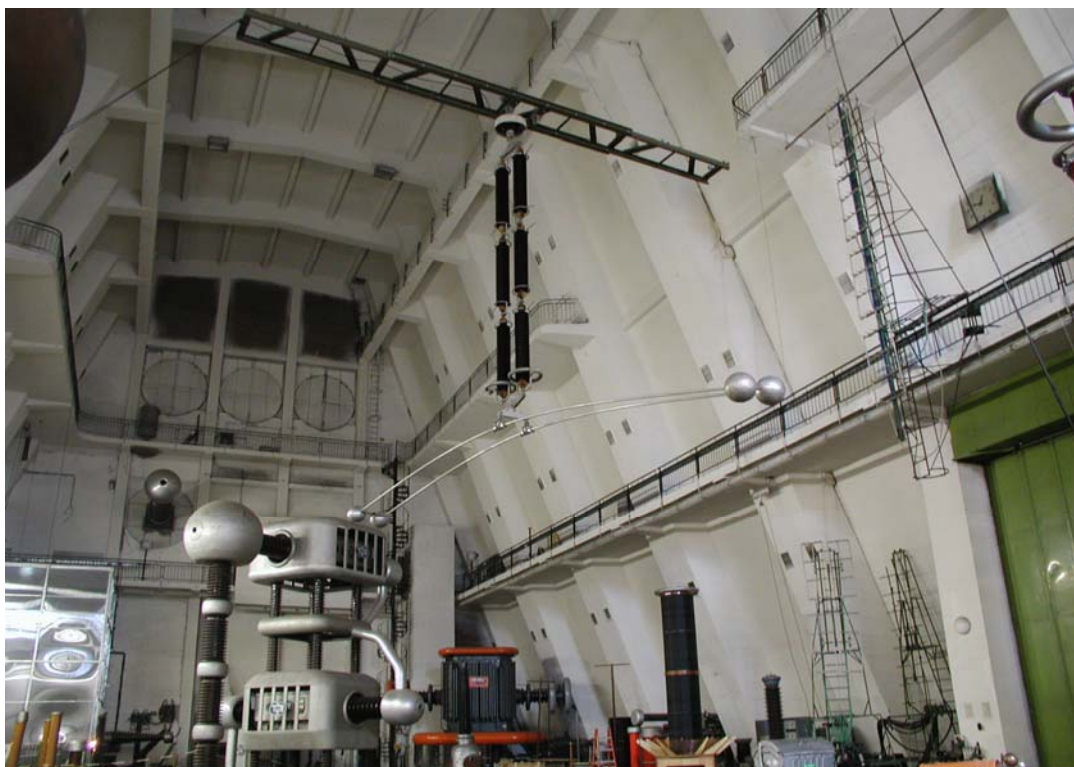
Obrázek 8 - Uspořádání závěsu 400 kV – DN 2 x 3 LS 75/21, tyčové izolátory
